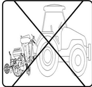
Makine Yanlış Bağlantı (Arkaya Eğik)
