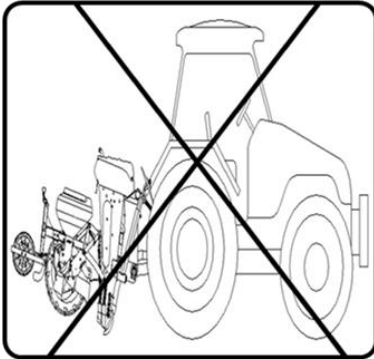
Makine Yanlış Bağlantı (Öne Eğik)
